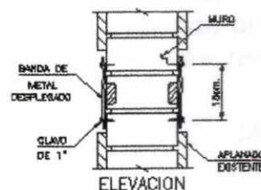
4to. COLOCAR BANDAS DE METAL DESPLEGADO CLAVADAS CON CLAVOS PARA HORMIGON DE 1" @ 15cm.
